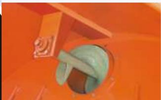
Sin fin cementado: Con material de aporte de alta resistencia al desgaste.
