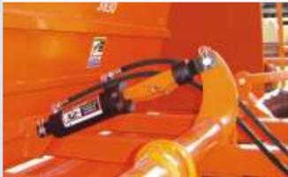
Sistema de levante y regulación de altura: Mediante eje giratorio accionado por cilindro hidráulico incorporado.
