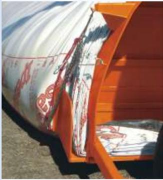
Bandeja inferior basculante: Con control efectivo de salida de la bolsa, y alerones de protección lateral.
