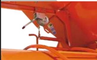
Sistema de carga de bolsa: Mediante aparejo manual con cable de acero y percha de izaje.
